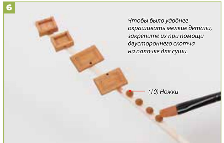
6 Окрасьте ящики, дверцы и ножки (10). Чтобы было удобнее окрашивать мелкие детали, закрепите их при помощи двустороннего скотча на палочке для суши.
