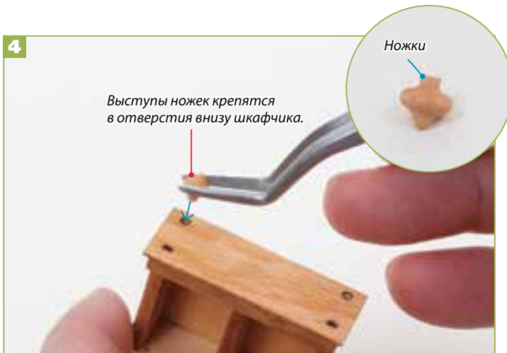
4 При помощи клея закрепите ножку в отверстии в нижней части шкафчика.
